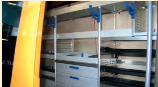
Fahrzeug für die Streckenwacht – als geschlossener Kastenwagen mit Hochdach und kompletter Werkstatteinrichtung sowie einem LED-Lichtwarnbalken
