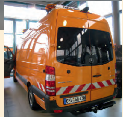
Fahrzeug für die Streckenwacht – als geschlossener Kastenwagen mit Hochdach und kompletter Werkstatteinrichtung sowie einem LED-Lichtwarnbalken
